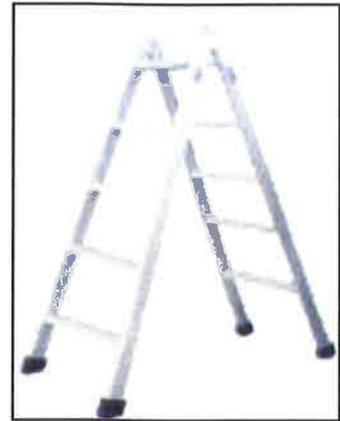
Las **escaleras dobles** se hallan formadas por la unión de dos escaleras sencillas, apoyadas una contra la otra por la parte superior y sujetas mediante un juego de bisagras que prestan una total seguridad de uso y aumentan su rendimiento de trabajo, puesto que pueden ser utilizadas por ambos lados, e incluso permiten el trabajo simultáneo de dos operarios.
