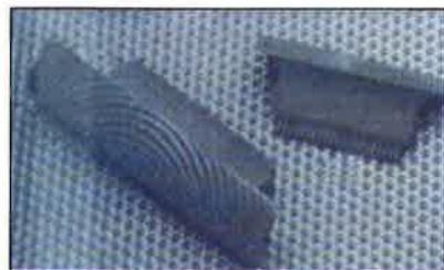
**Peines:** Para grabar rayas en la pintura todavía fresca y efectuar ciertos tipos de imitaciones se utilizan los denominados peines, provistos de un número determinado de púas, cuyo diámetro y separación está de acuerdo con la función del trabajo a realizar.
